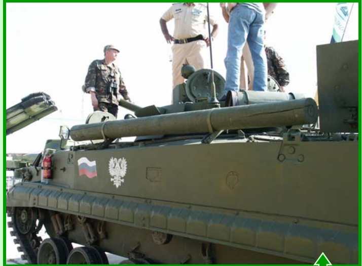
Un rondin de bois est placé sur le flanc gauche de la coque. A wood log is assembled to the left part of the hull.
