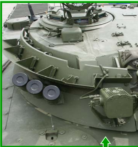
Trois lance-grenades fumigènes- placés à l'avant gauche et droit de la tourelle. Three smoke grenade dischargers place on the right and left front of the turret.
